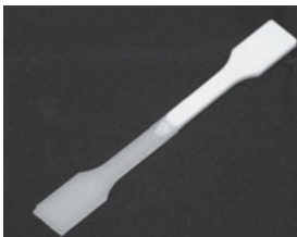
Abb. 4: Hybridbauteil mit kraftschlüssigem Übergang (LS-Teil oben; Spritzgießteil unten)
