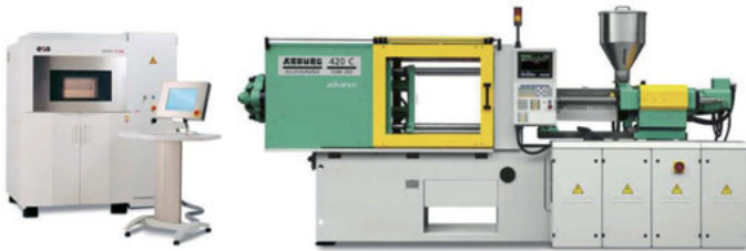
Abb. 3: Lasersintermaschine (links) zur Herstellung komplexer Geometrien Spritzgießmaschine (rechts) zum weiteren Verarbeiten und werkzeugegebundenen Formgebung
