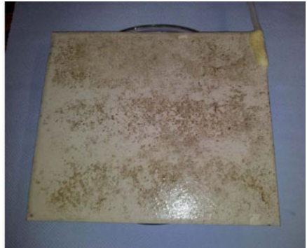
Abb. 30: Membrantasche (M 45) mit 0,5 Ma.-% TiO 2 nach Anwendung im Membranbioreaktor
