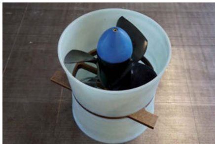
Abb. 15: links: Rotor-/ Generatoreinheit; rechts: Messung im fließenden Gewässer nur mit Einströmdüse
