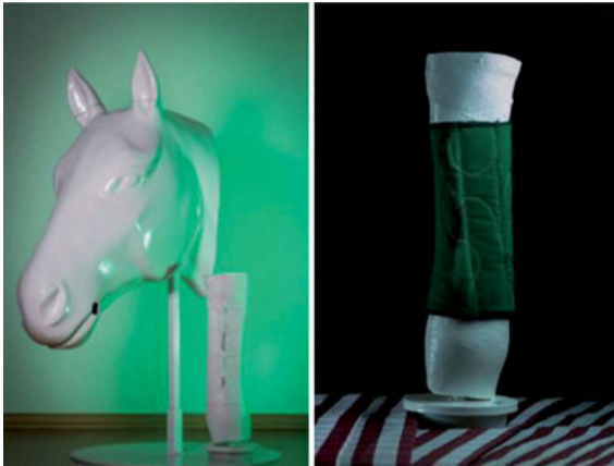
Abb. 24: links: Modelle zur Schnittabformung für den Kopf- und Beinbereich; rechts: mit Prototyp einer Gamasche
