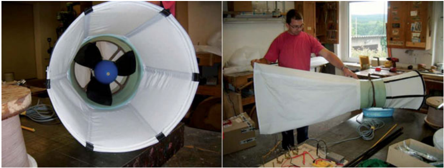
Abb. 16: links: Rotorelement mit textiler Einströmdüse; rechts: Gesamtansicht des Prototyps der Kleinwasserkraftanlage
