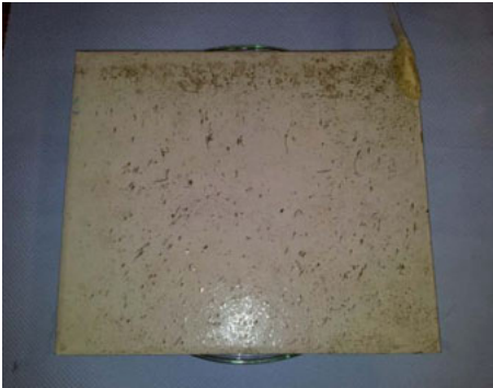
Abb. 29: Membrantasche (M43) mit 0,2 Ma.-% BaSO 4 nach Anwendung im Membranbioreaktor
