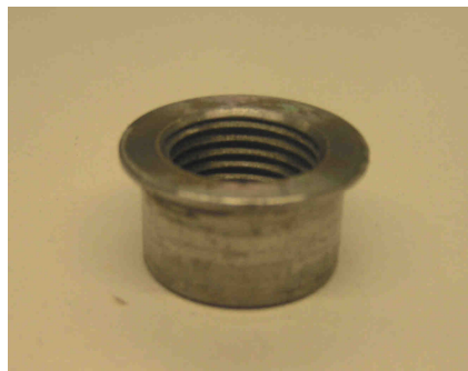
Bild 32: T-Hülse aus Stahl für Ölablassöffnung
