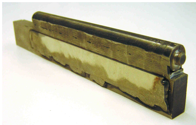
Bild 30: Werkzeug für Biege- und Schweißvorgang der U-Hülsen
