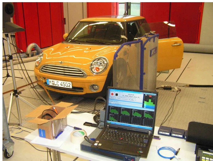
Bild 48: Frontend SQLab II mit Software ArtemiS 9
