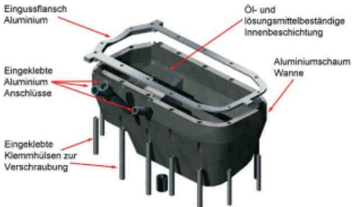
Bild 5: Aufbau eines Aluminiumschaum-Prototyps einer Ölwanne /4/
