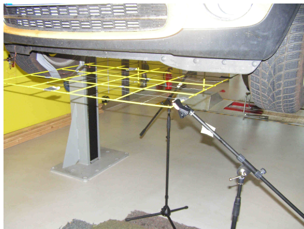
Bild 49: Unter dem Fahrzeug installiertes Gitter
