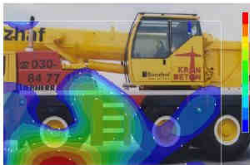
Bild 8: Hauptschallwellen-Lokalisierung mittels Beamforming /18/
