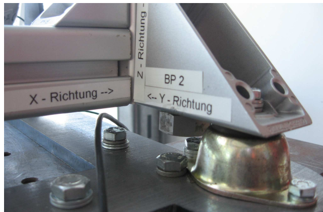
Bild 32: Gummilager an einem der Ankoppelpunkte
