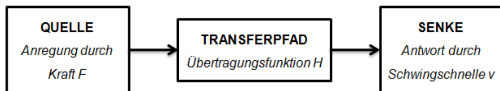
Bild 2: Prinzip der Transferpfadanalyse an einem Körperschallpfad /3/, S.363
