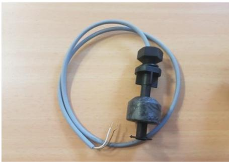
**Abbildung 34: Flüssigkeitsstandsensoren LS02**
