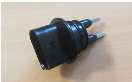
**Abbildung 35: OEM Scheibenwischwasserstandssensor**
