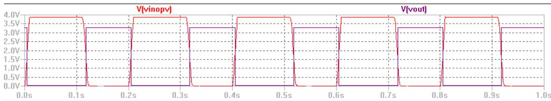
Abbildung 31: LTSpice Simulation digitale Eingangssignale
