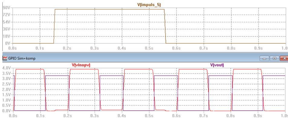
Abbildung 33: LTSpice Simulation digitale Eingangssignale mit Störung
