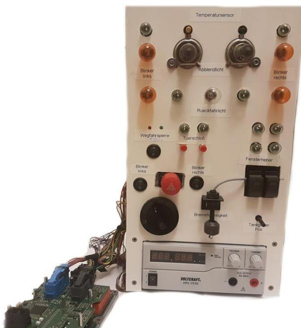
Abbildung 50: Versuchsaufbau Zentralsteuergerät mit Ersatzteilen des Apollo N
