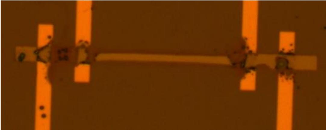
**Abbildung 35 Lichtmikroskopisches Bild nach einer Spannungsentladung des Keithleys an der Messstation ASTRID**
