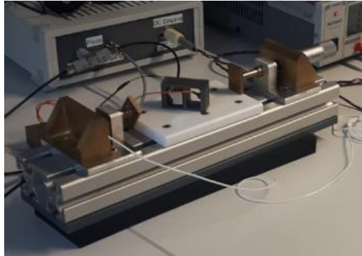
Abb. 22: Messaufbau Frequenz-Sweep mit neuem Implantat
