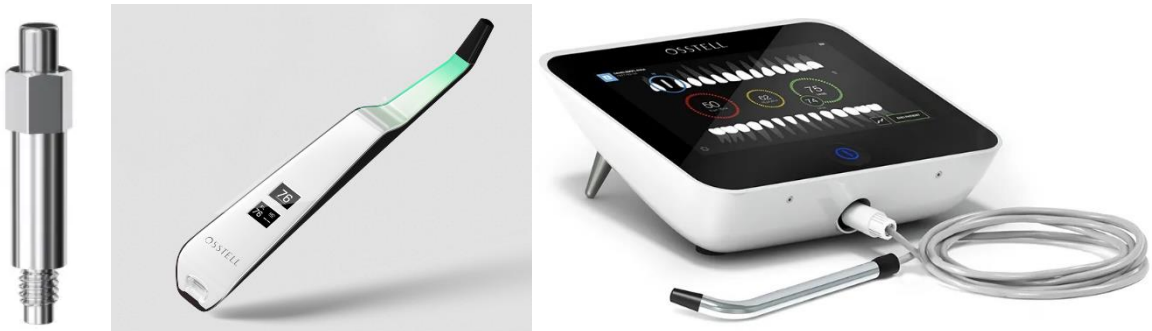
Abb. 1: Links: SmartPeg , das in das Dentalimplantat eingeschraubt wird. Mitte: Beacon , mobiles Gerät zur Anregung des SmartPegs und zur Messung des Implantatstabilitätsquotienten (ISQ). Rechts: Osstell IDx , Anregung des SmartPegs und zur Messung des ISQ. [5]
