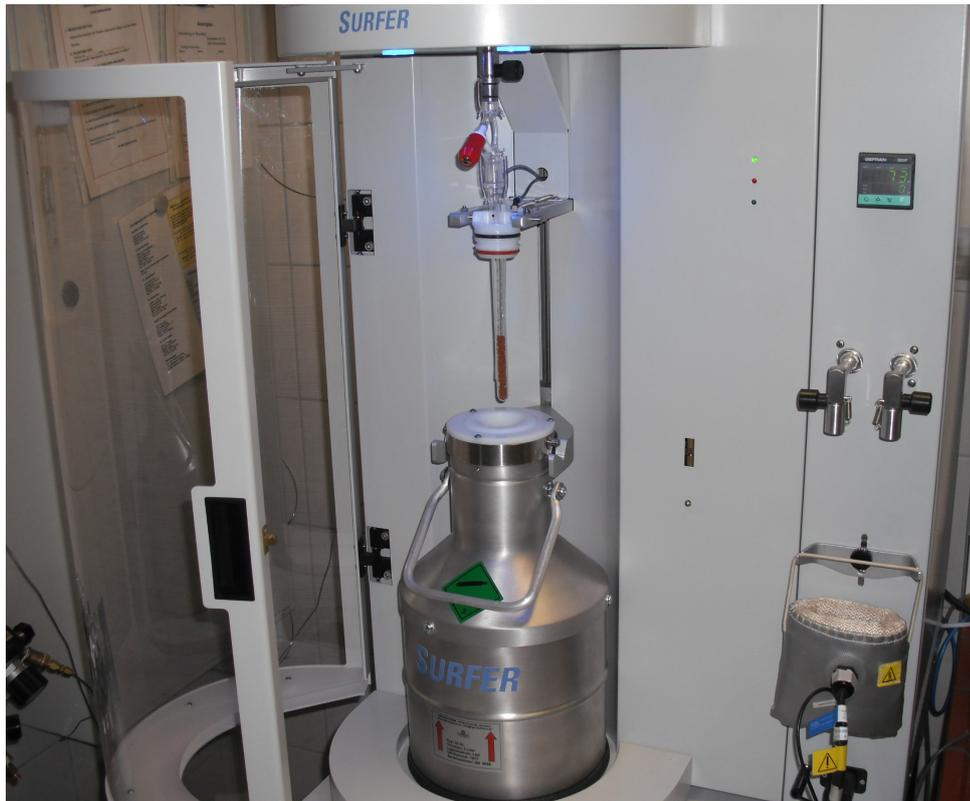
**Abbildung 3.7:** Versuchsaufbau der Stickstoffsorption.
