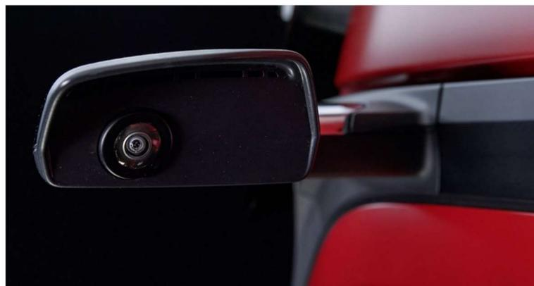
Abbildung 12: seitlich angebrachte Mirrorcam am Dachrahmen [20]
