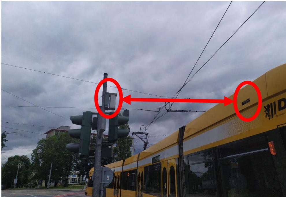
Abbildung 3: Eine Straßenbahn fährt an einer Funkbake vorbei und löst eine Meldepunktkette aus, eigene Aufnahme
