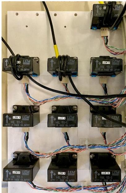
**Abbildung 42** Stromwandler mit drei gewickelten Phasenleitern
