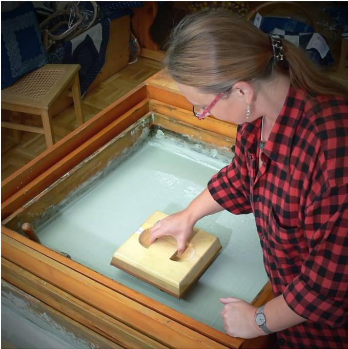
*Abb. 2: Papp wird mit Hilfe eines Modells aus Streichkasten aufgenommen*
