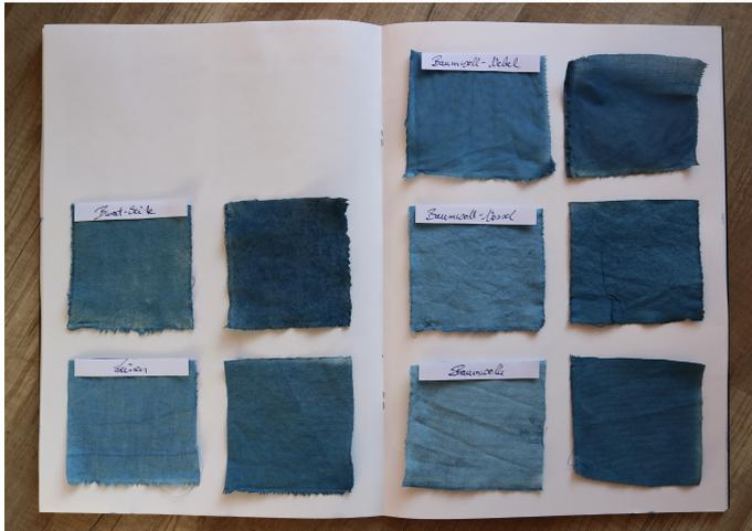
Abb. 14: Erprobung mit Indigo-Kaltfärbung auf verschiedenen Materialien
