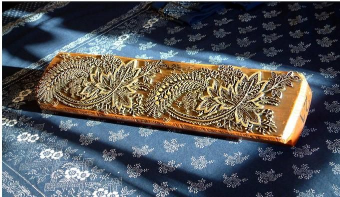
*Abb. 5: Holzmodel mit eingearbeiteten Messingstiften und -bändern*
