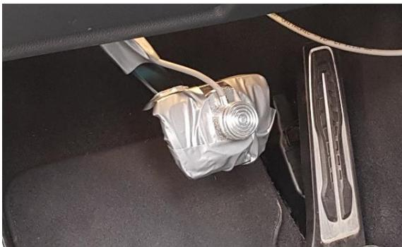
*Abbildung 22 Im Messfahrzeug eingebauter Pedalkraftsensor*
