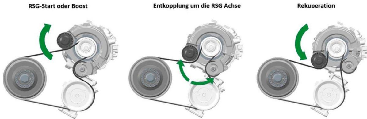
Abbildung 11 Riemen-Spannvorrichtung des Riemen-Starter Generator (RSG) (8)
