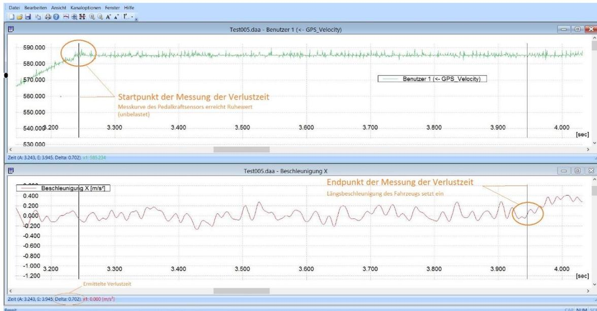
Abbildung 34 Ausmessen der Verlustzeit (von Messpunkt des Pedalkraftsensors erreicht Ruhewert, bis einsetzen der Längsbeschleunigung)
