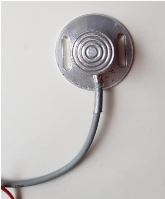
*Abbildung 20 Pedalkraftsensor
