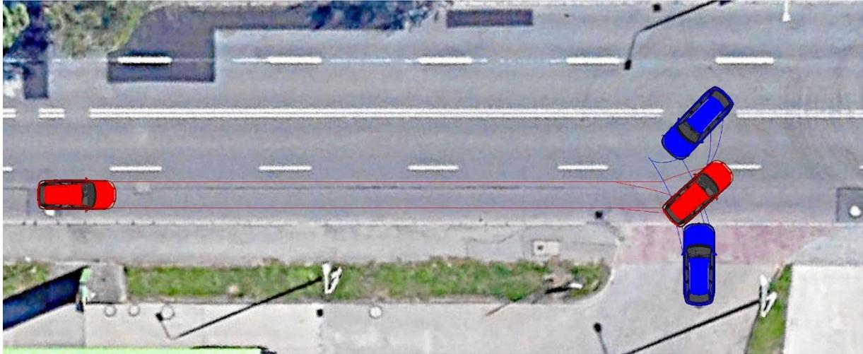
*Abbildung 43 Simulation mit Verlustzeit des aktivierten Start-Stopp-Systems*
