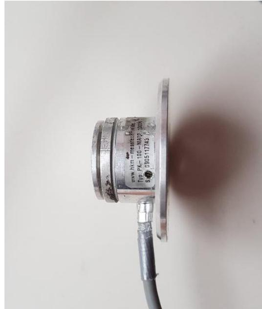
*Abbildung 21 Pedalkraftsensor
