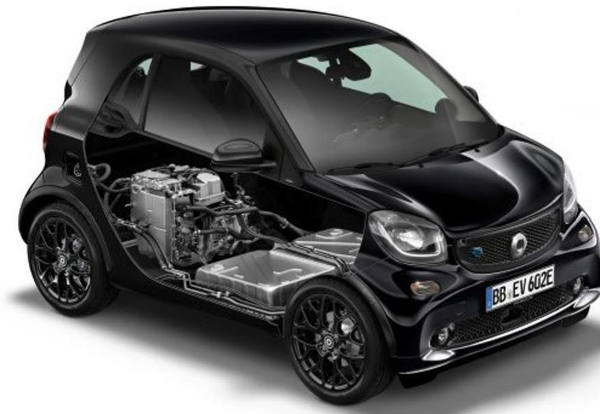
**Bild 7-22 Benz Smart EQ Kleiner Batteriepack**
