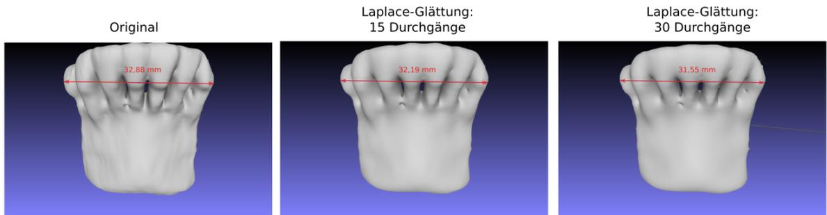
**Abbildung 51:** Schrumpfeffekt mit Laplace-Filterung: Dabei nimmt der Effekt bei mehrfacher Wiederholung stark zu.
