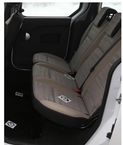
Bild 62: FARO-Marker im Fahrzeuginnenraum
