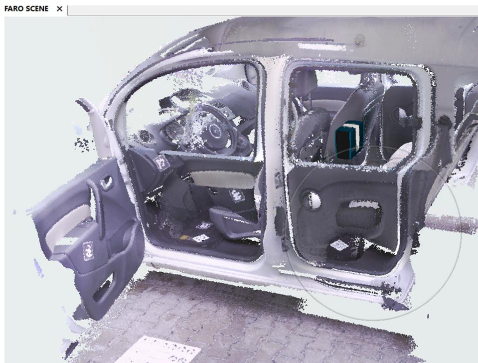
Bild 75: Berechnete 3D-Punktwolke in FARO SCENE
