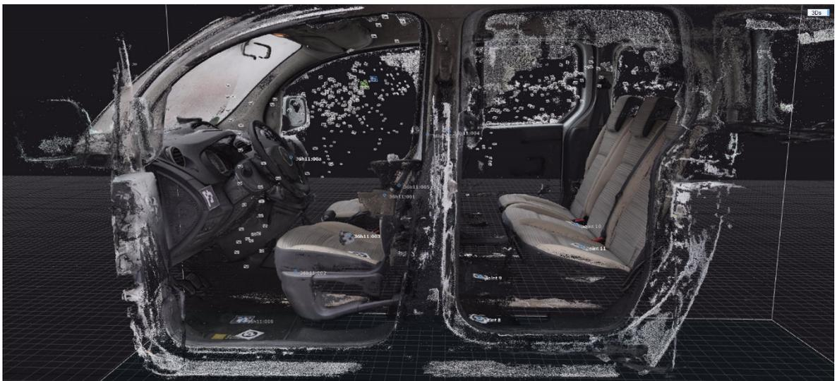
Bild 85: Erstellte Punktwolke zum Versuch der 3D-Photogrammetrie
