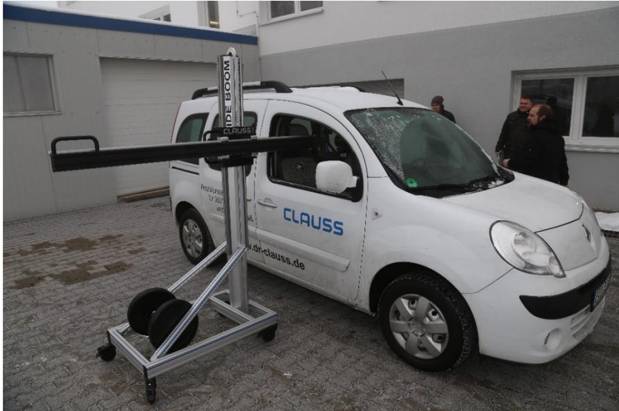
Bild 83: Durch die Beifahrertür geführtes Panoramasystem
