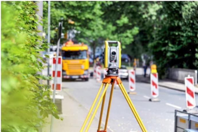
Bild 8: Tachymeter [18]
