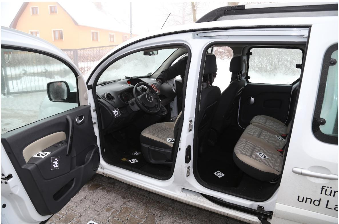
Bild 79: Im Fahrzeuginnenraum verteilte Marker
