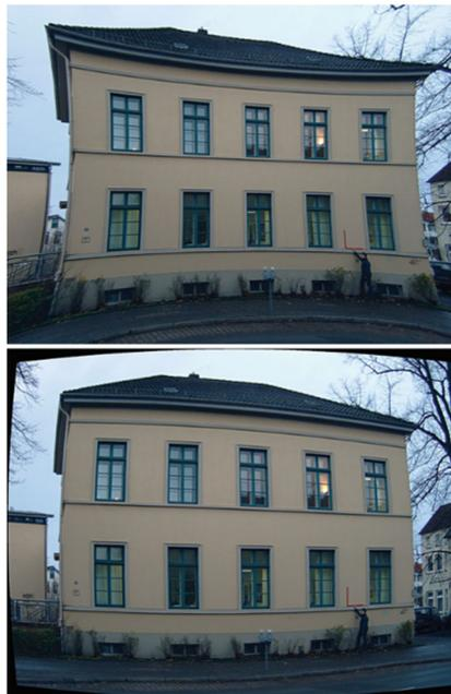
Bild 27: Kissen- und tonnenförmige Verzeichnung in einem aufgenommenen Bild [13]
