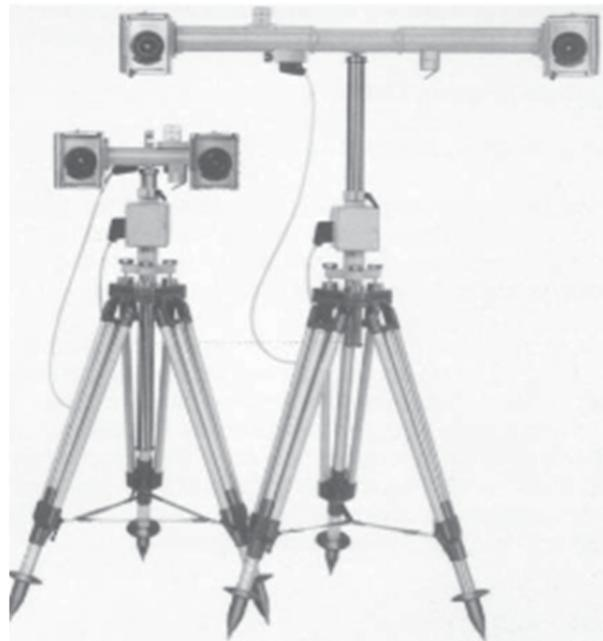
Bild 14: Stereomesskammern Zeiss SMK 40 und SMK 120 (rechts) [10]
