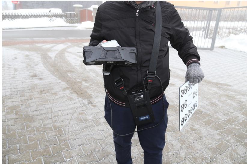
Bild 60: Handgeführter FARO Freestyle 2 Scanner
