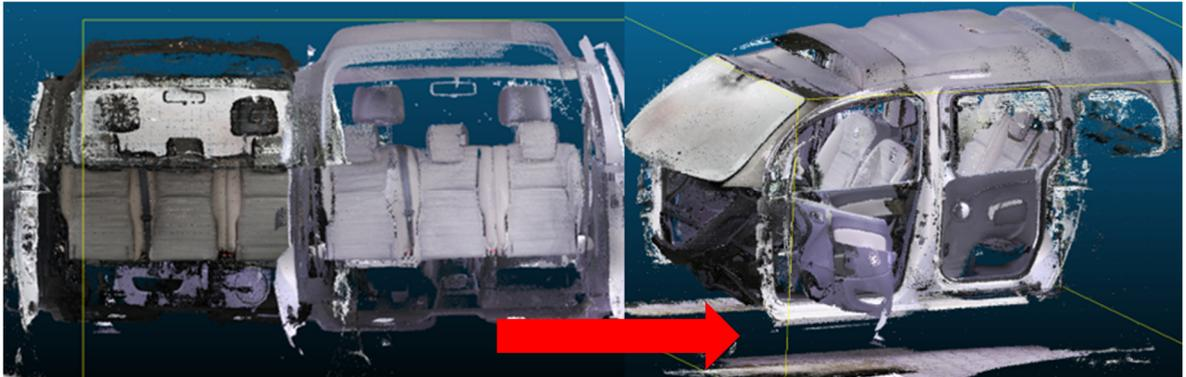
Bild 90: Ausrichten der Punktwolke mit der Funktion „Translate, Rotate“
