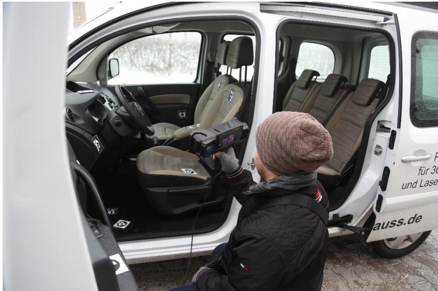
Bild 81: Scanvorgang durch die geöffnete Fahrertür
