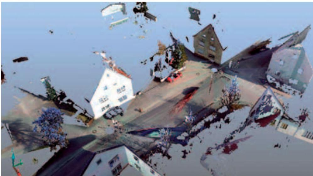
Bild 39: 3D-Punktwolke in Farbe, erzeugt aus zwei Scanpositionen [21]
