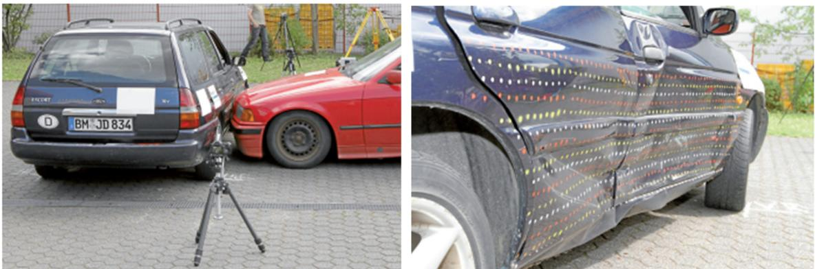
Bild 34: Versuchsdurchführung des Crashes (links) [19]
