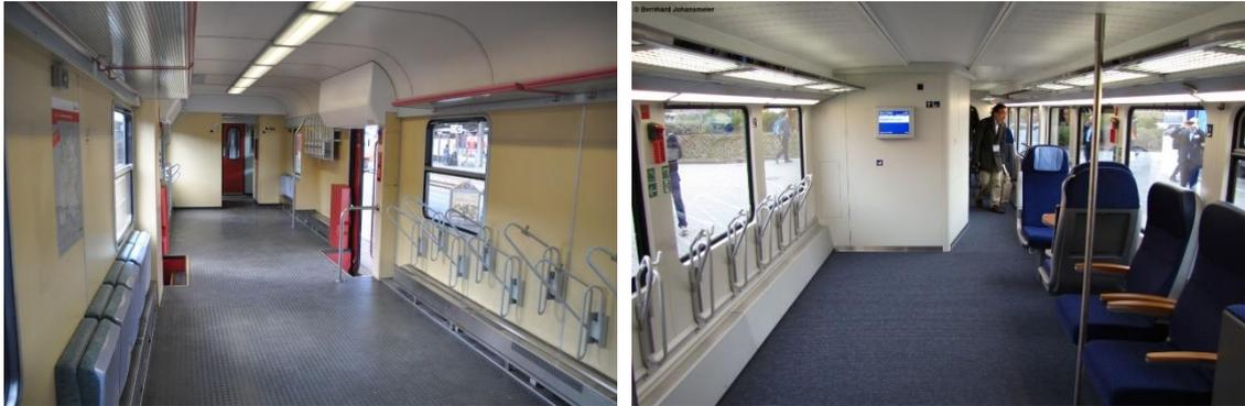
Bild 3: Spitzwinklig ausgerichteter Fahrradständer in Kombination mit Sitzen [3], [4]
