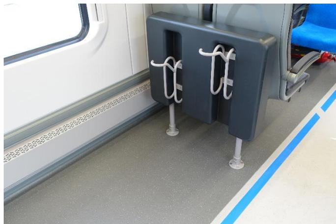
Bild 2: Längsausgerichteter Fahrradhalter
