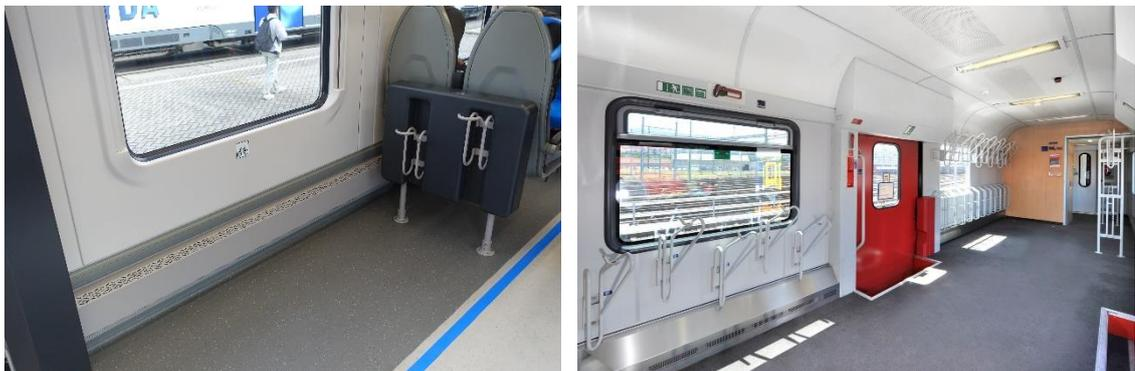
Bild 5: Platzverbrauch bei unterschiedlicher Halterpositionierung; Bild rechts: [5]
