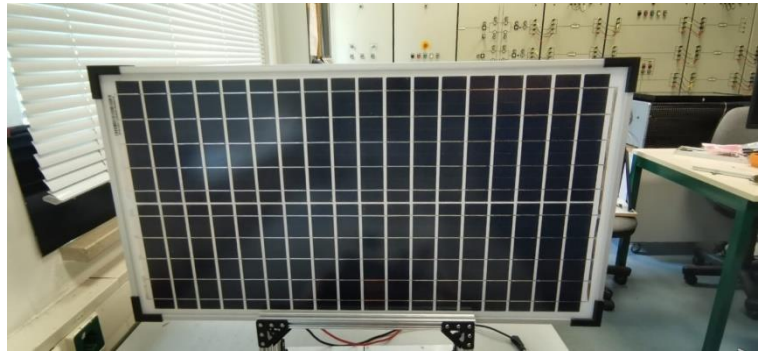
Abbildung 6: Zelle (links) [4] und Modul (rechts) auf Basis von polykristallinem Silizium
