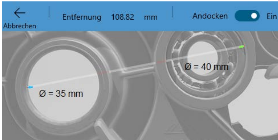
Bild 21: maximaler Abstand der Gehäusebohrungen [48]
