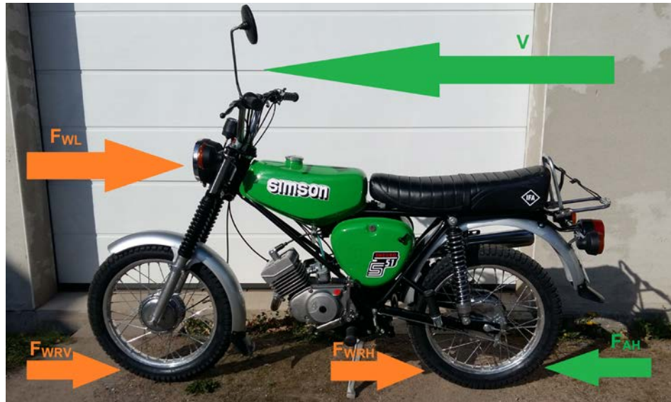
Bild 18: Fahrwiderstände einer Simson S51 Enduro [43]
