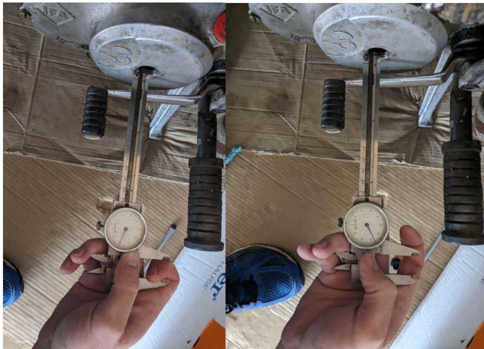
Bild 22: Ermittlung des Lüftwegs der Kupplung eines M541 Motors [49]
