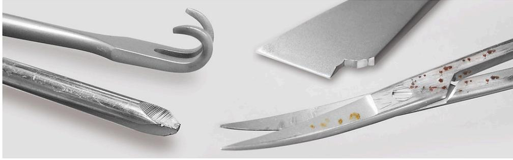
Abb. 6: Beispiel für Verunreinigungen und Defekte an Instrumenten [26]
