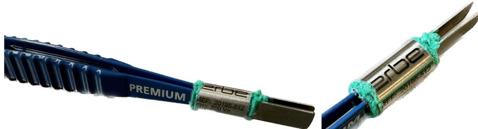
Abb. 16: Beschädigung bipolare Pinzette [e. A.]
