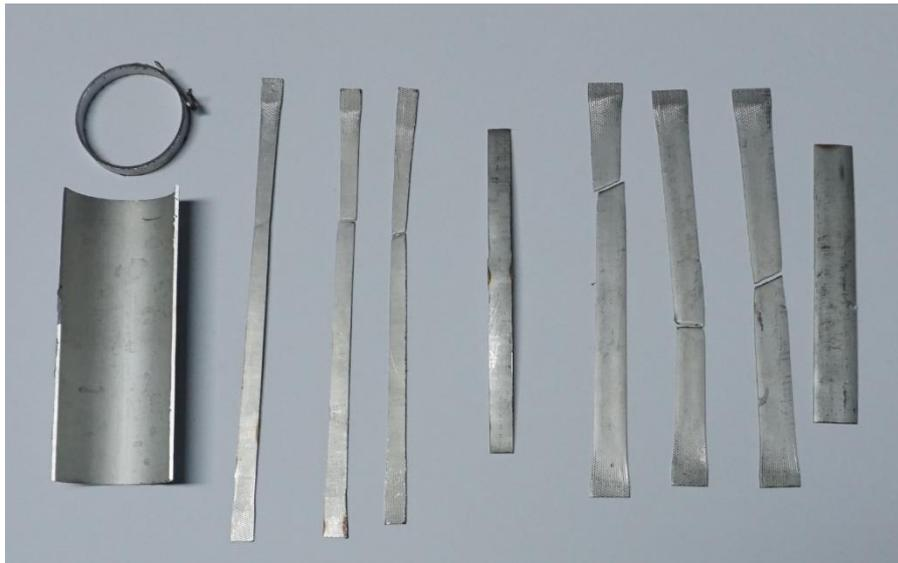
**Abbildung 75** Zugproben, links Querproben und rechts Längsproben [eigene Darstellung]
