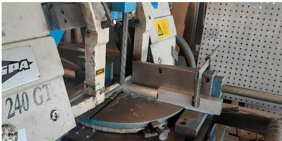
**Abbildung 39** Zuschnitt mittels Bandsäge
