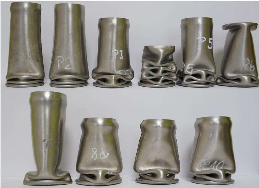
Abbildung 47 Deformierte Proben (Probe P01 bis P10 von links nach rechts) [eigene Darstellung]
