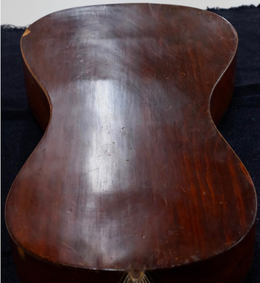
*Abbildung 27: Eingefallener Boden zwischen den Leisten*
