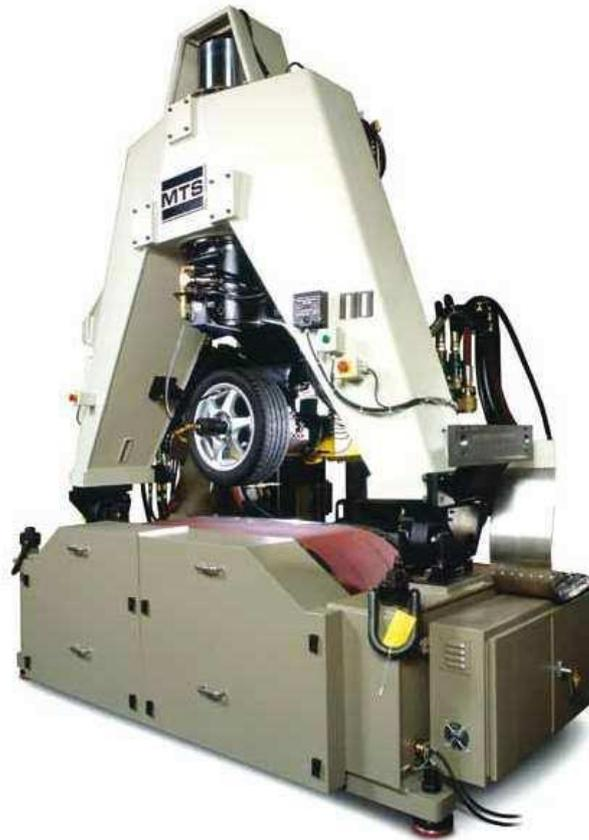
**Abbildung 2-15: Reifenprüfstand Flat-Trac III CT der Firma MTS Systems /MTS-24/**
