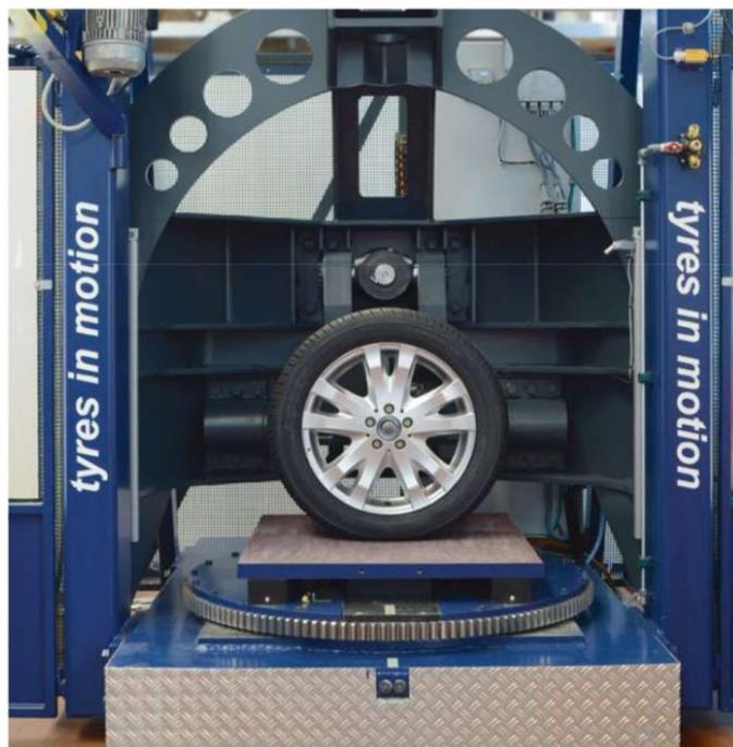
Abbildung 2-16: Steifigkeitsprüfstand des IKA der RWTH Aachen /BACH-17/
