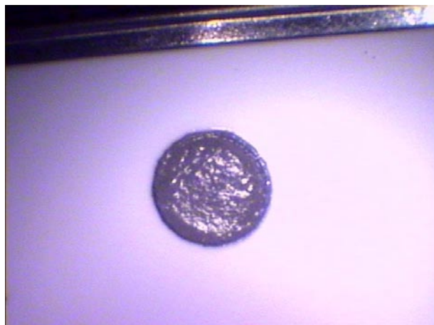
Abbildung 38: Lotkugeltest, Lotpaste auf Keramikplättchen
