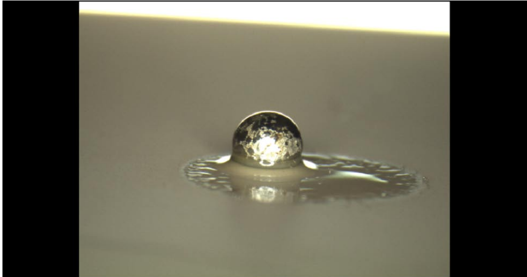
Abbildung 39: Lotkugeltest, umgeschmolzenes Zinn-Silber-Kupfer
