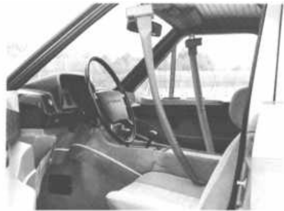
Befestigungspunkt wird nach dem Schließen der Tür elektromotorisch nach hinten verfahren
