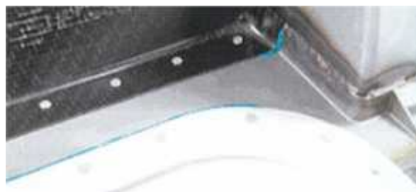
Bild 50: Beispiel Hochgeschwindigkeitsbolzen-Setzung [25, S. 822]
