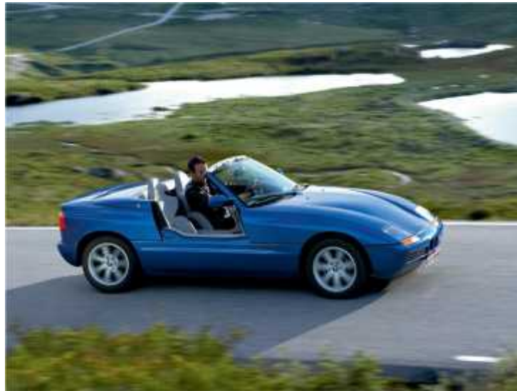
Bild 1: BMW Z1 mit versenkbarer Tür [1]
