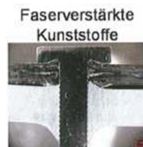
Bild 48: Schlißbild Hochgeschwindigkeitsbolzen [25, S. 810]
