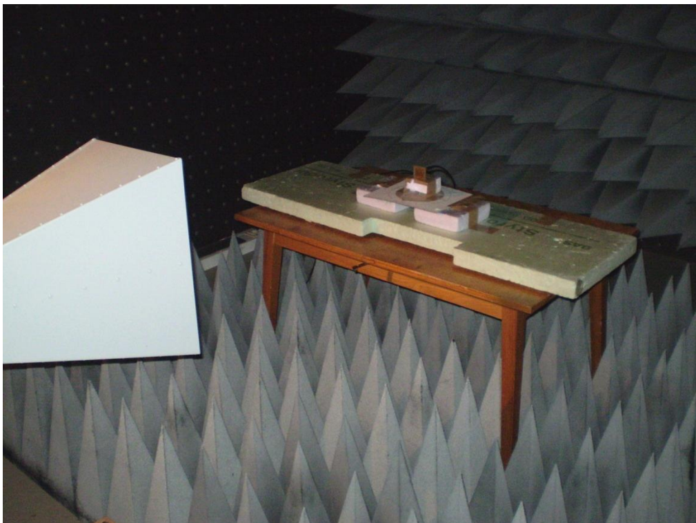
Abbildung A 12 Messaufbau in Messkabine - Messung Strahlungsdiagramm 2
