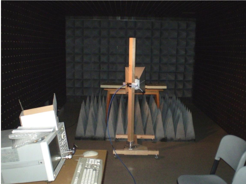
Abbildung A 11 Messaufbau in Messkabine - Messung Strahlungsdiagramm
