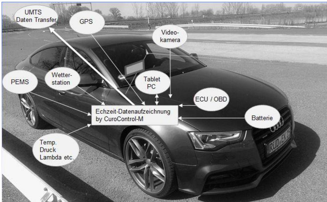
Bild 7: Funktionschema der Messtechnik
