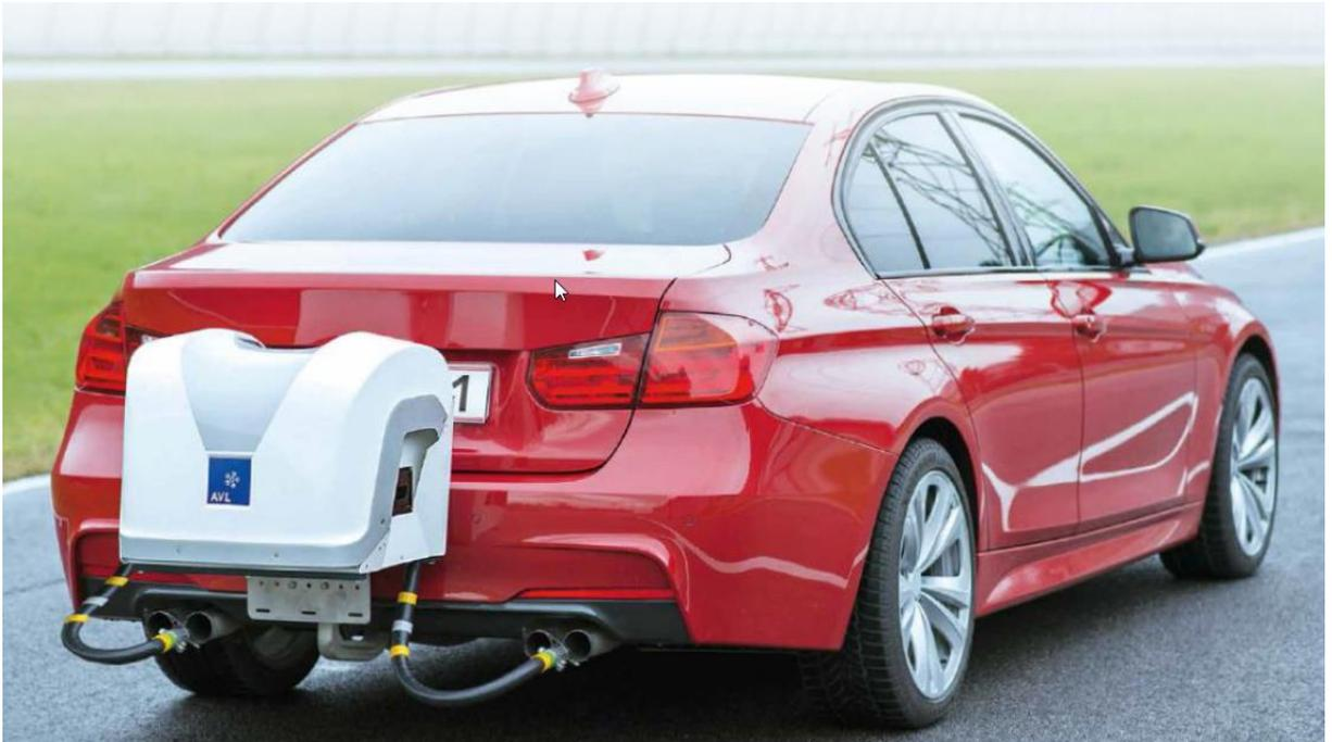
Bild 2: RDE-Fahrzeug mit Gas-PEMS
