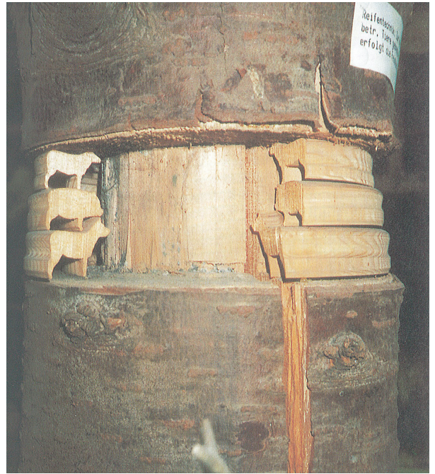
Abb.8: Tierreifen werden aus Rundholz quer zum Stamm gedreht. Sehr anschauliche Darstellung im Werkner- Mu- seum, Kehl- Kitterburg.
