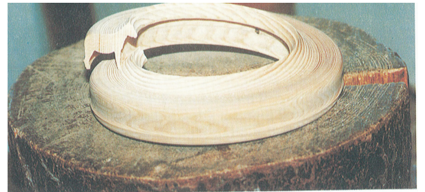
Abb.8: Tierreifen werden aus Rundholz quer zum Stamm gedreht. Sehr anschauliche Darstellung im Werkner- Mu- seum, Kehl- Kitterburg.
