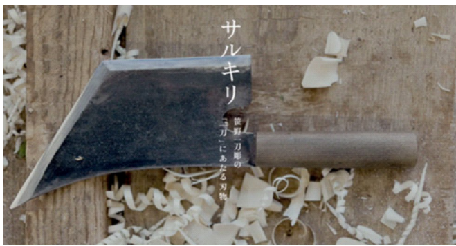
Abb.2: Sarukiri 1, Ein spezielles Schnitzmesser
