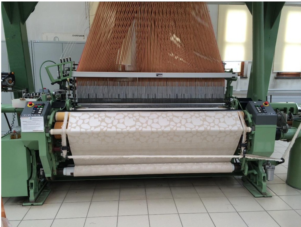
Abb. 15 Weben eines Stoffes auf einer Jacquardwebmaschine der Firma Dornier
