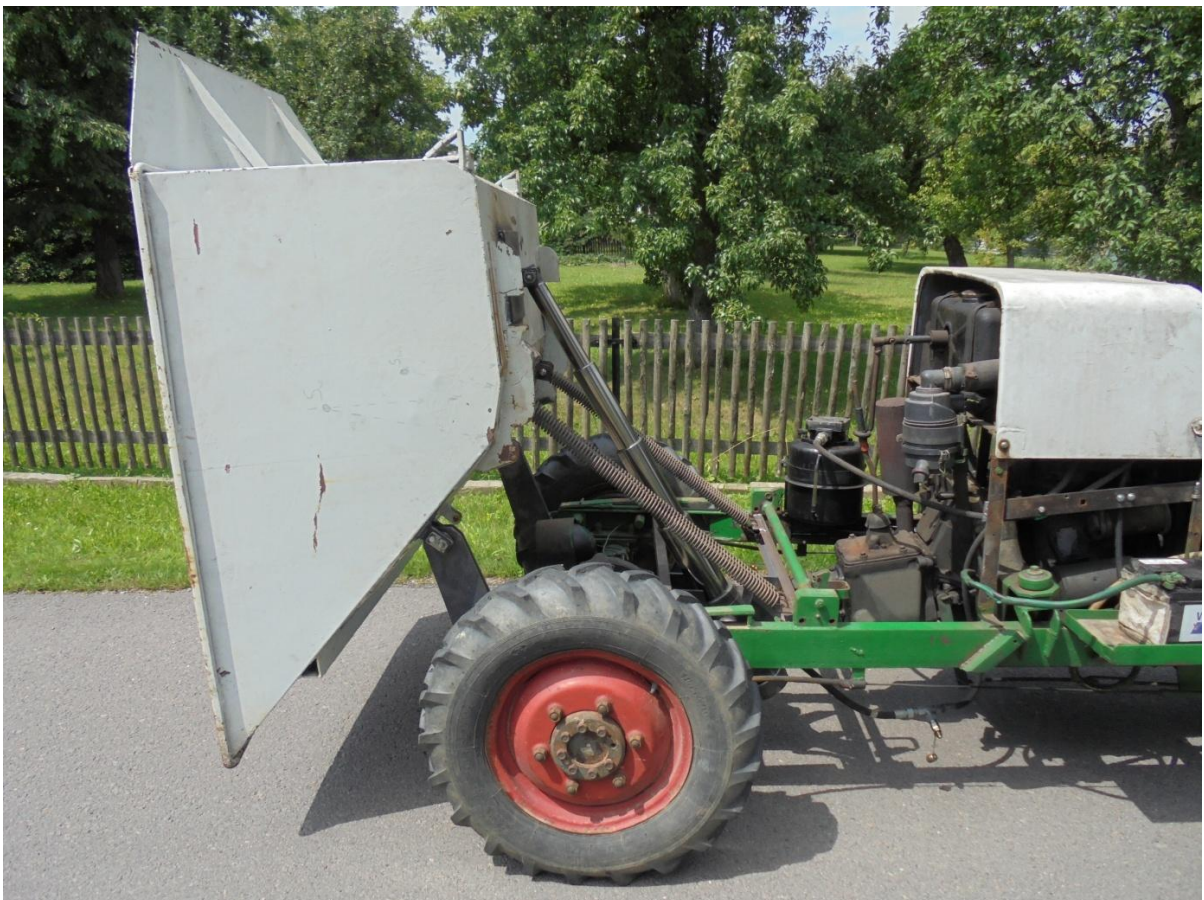
Bild 57: Endlage des Teleskopzylinders
