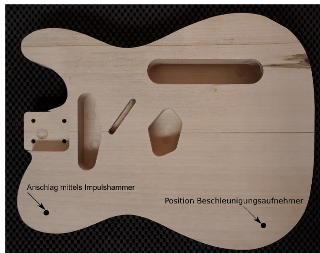
Abbildung 11: Positionierung des Beschleunigungsaufnehmers & Impulshammers am Korpus
